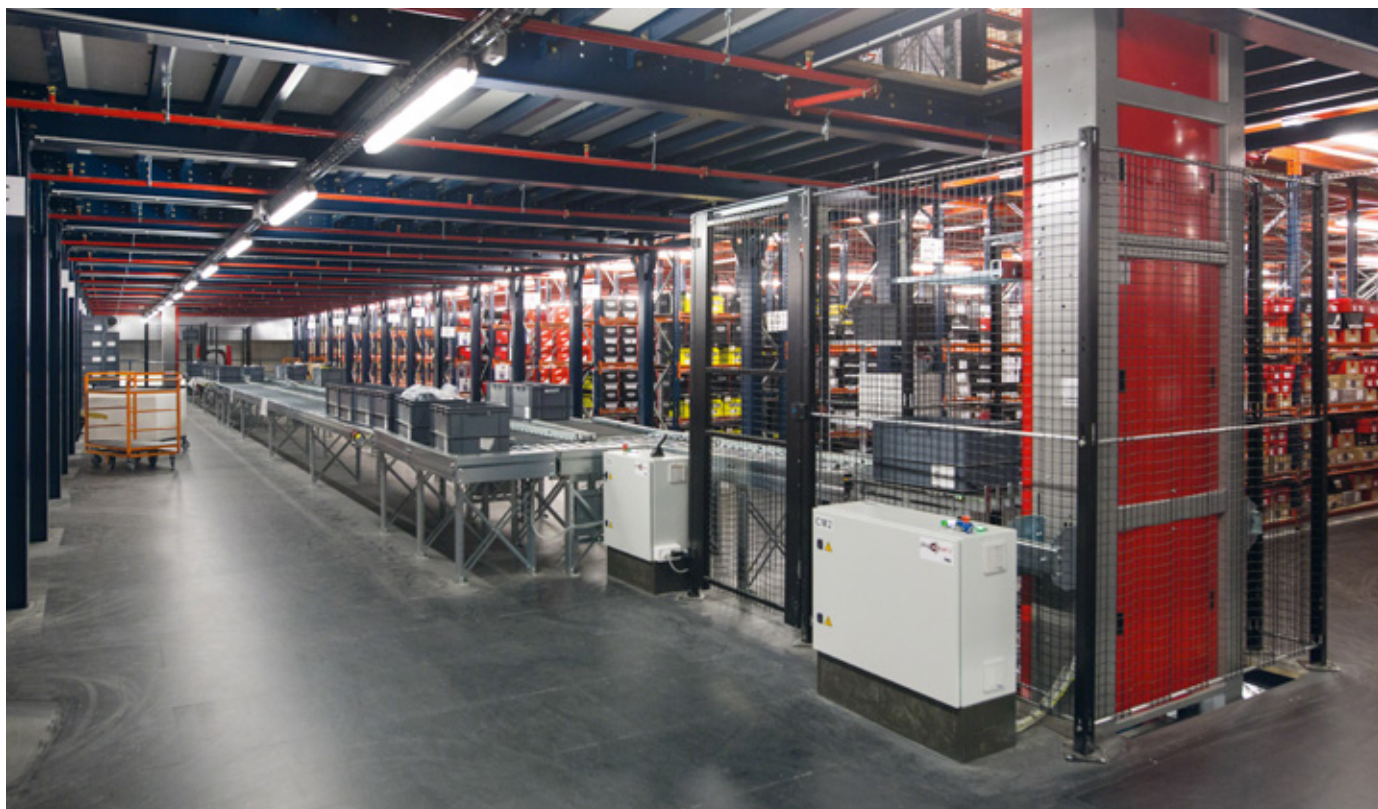
Automatyczna winda pojemnikowa transportuje pojemniki na odpowiednie kondygnacje
