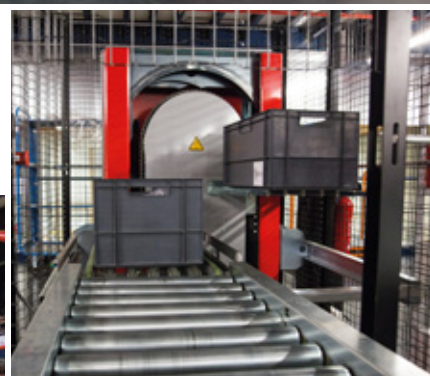
Automatyczna winda pojemnikowa transportuje pojemniki na odpowiednie kondygnacje
